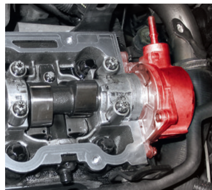
Bomba de vacío y árbol de levas en el Opel Vectra B (resaltados)
